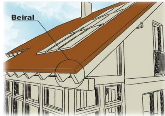
Beiral é a projeção externa do telhado que extravasa a projeção do edifício
