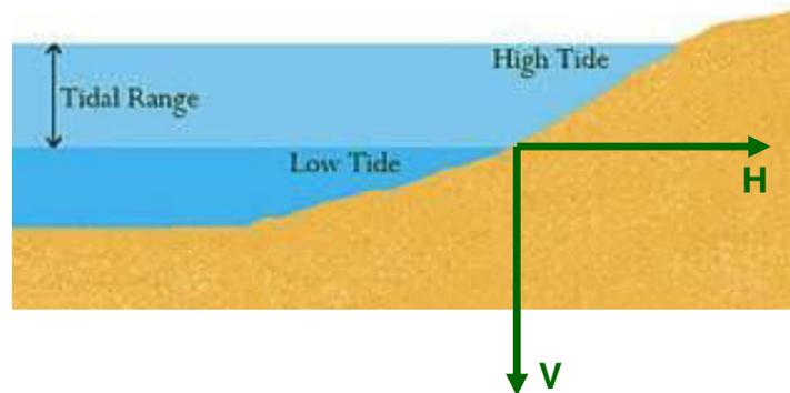
COMPONENTES HORIZONTAL E VERTICAL DA FORÇA QUE ACTUA NA PARTE SÓLIDA RESULTANTE DA SUBIDA DA MARÉ
