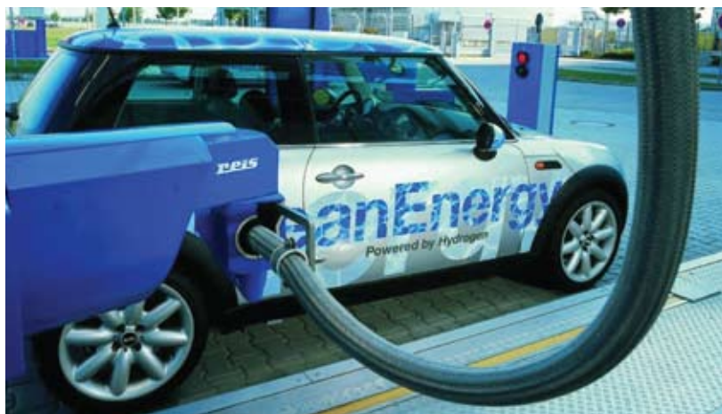
Hidrogénio - Veículos e sistema de abastecimento experimentais
